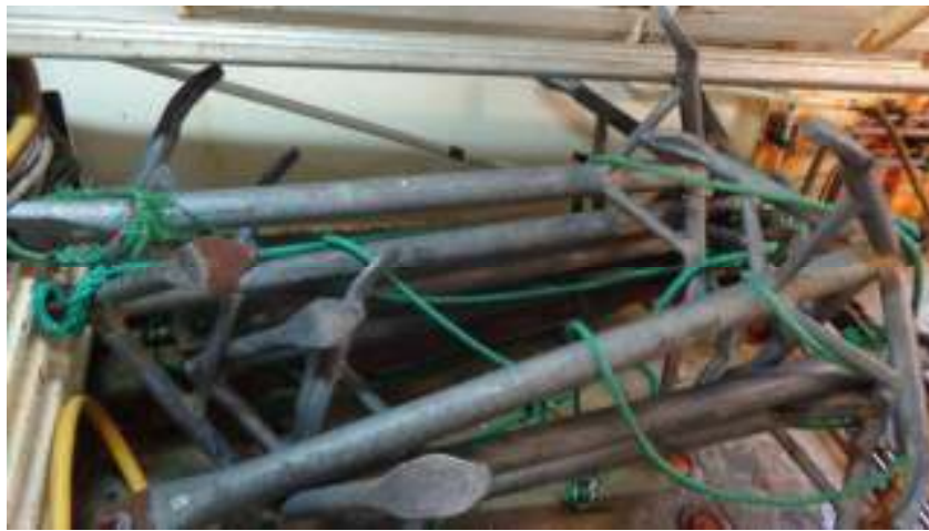
Figura 6. Ancla tipo rezón de tres patas, anclaje línea de pesca (BP Proa Pioneer).
