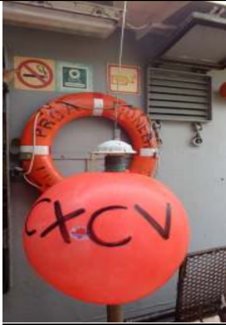
Figura 5. Radio-boya A4-A5, identificación y ubicación de línea de pesca (BP Proa Pioneer).
