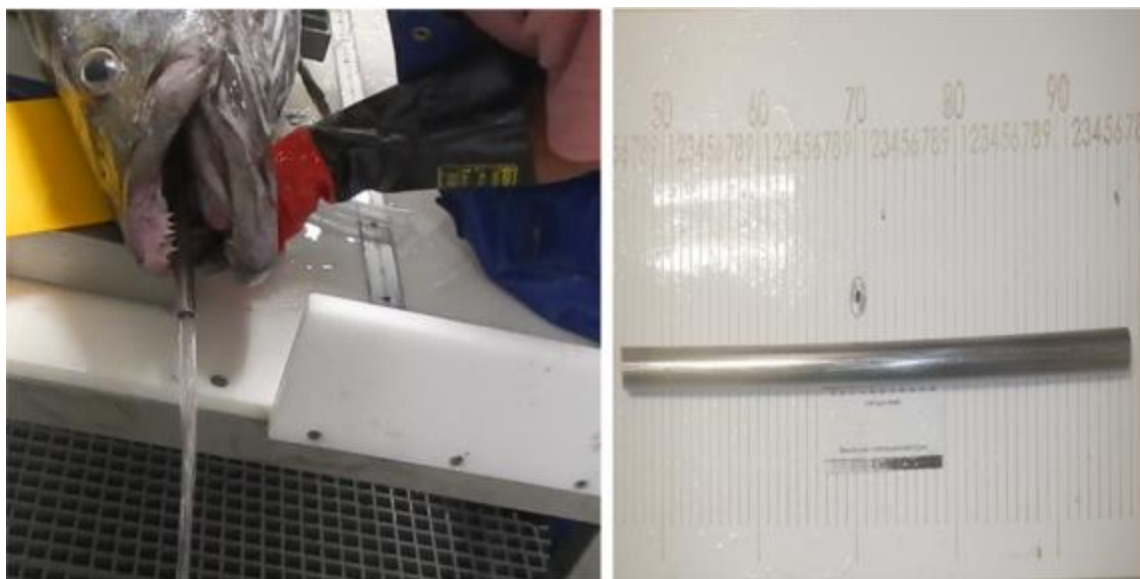
Рис. А1: Демонстрация трубки для сливания, используемой для слива воды из желудков клыкача.
